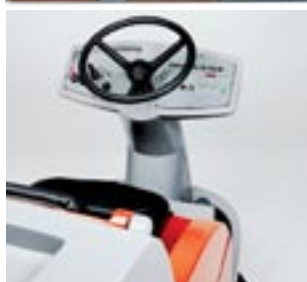
Tydlig manöverpanel Bekvämlig förarstol med lättgående styrning. Skurborstarna är skyddade av kollisionsbåge.
