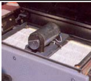
3 m 2 filteryta med elektrisk filter-skakning. Mer än 99% dammvaskning.
