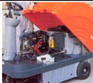
Snabb friläggning av maskinens inre för underhåll och snabb service.
