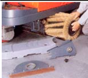
Patenterad huvudborste med utvecklat skydd mot upprullning av skräp runt borstnaven.
