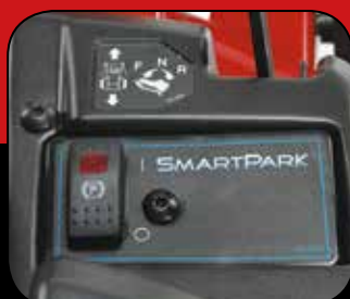
SMART PARK™ Toros unika automatiska handbroms-system ser till att klippaggregatet stängs av när du kliver ur stolen utan att motorn stannar.
