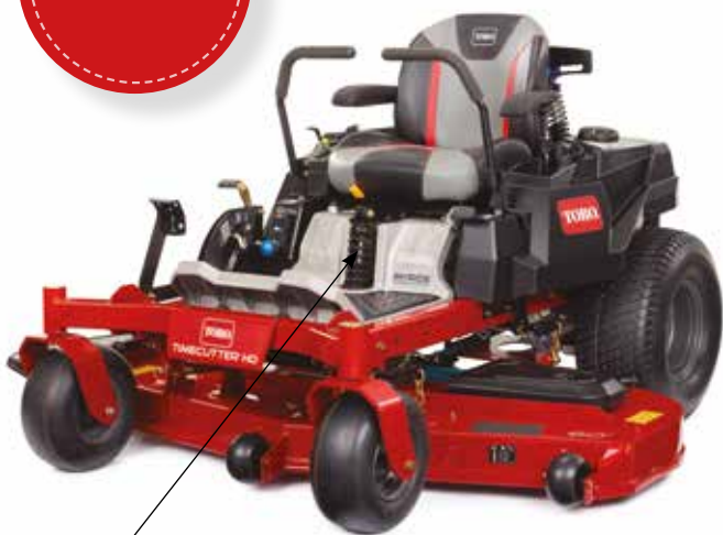
Avfjädrad förarplattform – MyRide Suspension System Toros nya avfjädrad förarplattform med ställbara fjädrar ger en bekvämare och högre körupplevelse.
