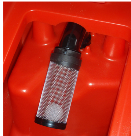
Silen i smutsvattentanken Vid varje vattenpåfyllning skall silen i renavattenbehållaren kontrolleras. Flottörkulan skall vara lättroglig och silen skall vara ren. Se sidan 26
