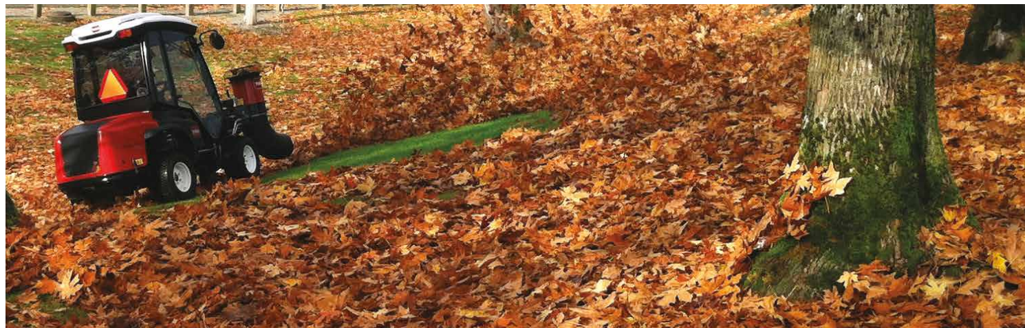
Vertikalt fäste – fästs på det främre QAS-systemet på Groundsmaster 360 med fyrhjulsdraft – ökar mångsidigheten
