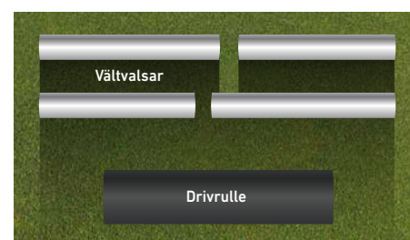
Konstruktion med förskjutningsbara vältvalsar för ett jämnt intryck och optimala spelförhållanden
