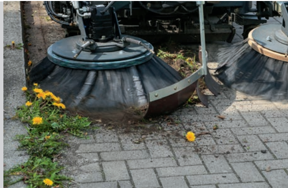
Kemikaliefri ogräsbekämpning med ogräsbörste för mekanisk borttagning och uppsamling av ogräs.
