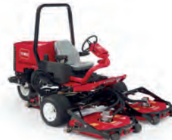
TORO GROUNDSMASTER 3505-D KLIPPBREDD ..... 183CM KLIPPHÖJD ..... 19MM-102MM KLIPPKAPACITET .. 1,4HA/TIM MARKFÖLJANDE KONTURKLIPPDÄCK
