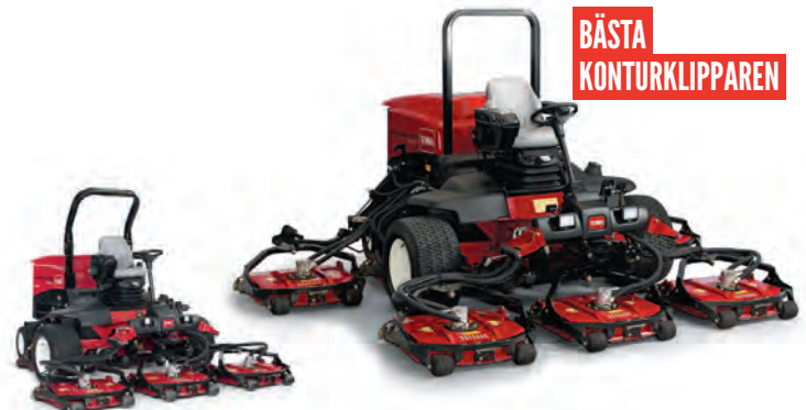
TORO GROUNDSMASTER 4500-D KLIPPBREDD ..... 277CM KLIPPHÖJD ..... 19MM-102MM KLIPPKAPACITET .... 3HA/TIM SMARTCOOL-SYSTEM, SMARTPOWER, KONTURKLIPPDÄCK
