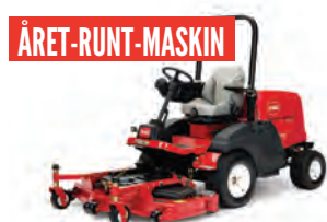
TORO GROUNDMASTER 3200/3300 KLIPPBREDD ..... 152CM, 183CM KLIPPHÖJD .....25MM-152MM KLIPPKAPACITET ...2,95-3,52HA/TIM SLAGHACK, VINTERUTRUSTNING SOM TILLVAL, HYTT, 2 OCH 4-HJULSDRIFT ÄVEN I ELEKTRISK VERSION
