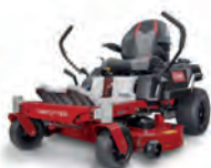
TORO TIMECUTTER MX4275T/5275 KLIPPBREDD ..... 107,127CM KLIPPHÖJD ..... 38MM-114MM RECYCLER, MYRIDE-SYSTEM, SVETSAT KLIPPDÄCK
