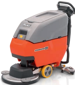
Scrubmaster B50 – finns som tillval med orbitalteknik för förbättrade rengöringsresultat och minskat borstslitage tack vare ökad borststabilitet och rengöring via borstspetsarna.
